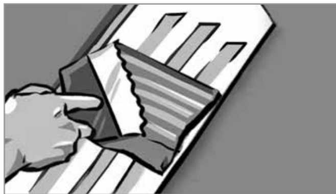
Рис. 6. Нанесение монтажного клея на элемент декора.
